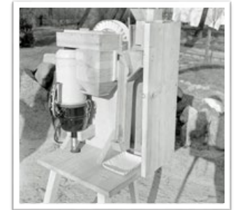
Steigsichter mit Dosier- einrichtung aus einem „Siemens“-Staubsauger
